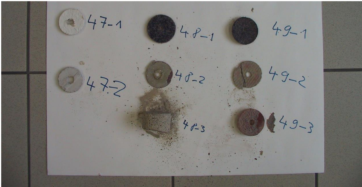
Abbildung 68 Beispiel für Materialuntersuchungen - Kernbohrung und Steinholzestrich als Quelle für phenolische Verbindungen (Quelle: LAV)
