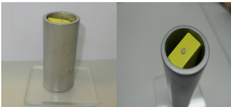
Abbildung 21 Nachweis der Verschluckbarkeit eines Teils aus einem Holzpuzzlespiel für Kinder unter 36 Monaten mittels standardisiertem Prüfzylinder
