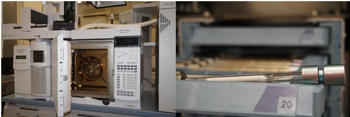
Abbildung 5 Links - Gaschromatograph mit massenselektivem Detektor Rechts - Thermodesorptionsröhrchen aus Glas mit sichtbarer Sorbensfüllung (Tenax TA) (Quelle: LAV)
